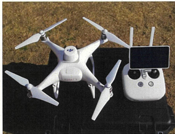
測量に使用する UAV
